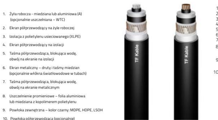
Rys. 1 Budowa kabla elektroenergetycznego.
